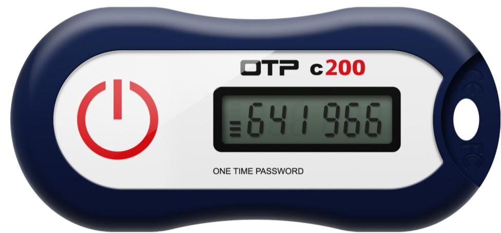
دستگاه رمزیاب C200، دستگاه تولید رمز یکبار مصرف و تصادفی بر مبنای زمان می باشد. این سخت افزار امکان احراز هویت دو عاملی و اصالت کاربران سیستم را به سادگی فراهم می سازد. در این رمزیاب هر ۶۰ یا ۳۰ ثانیه یک رمز عبور با استاندارد IETF Time-based Authentication که توسط OATH ارائه شده تولید و با فشردن دکمه به کاربر نشان داده می شود، کار با این دستگاه برای کاربران بسیار ساده بوده و به راحتی قابل استفاده می باشد.
